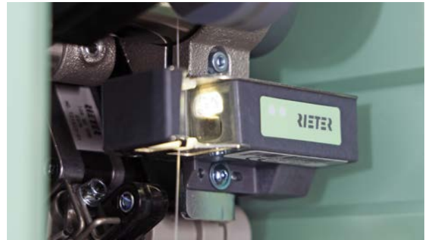
Fig. 5: Limpiador de hilos Q 30A: efectivo control de calidad para hilos elaborados con chorro de aire
