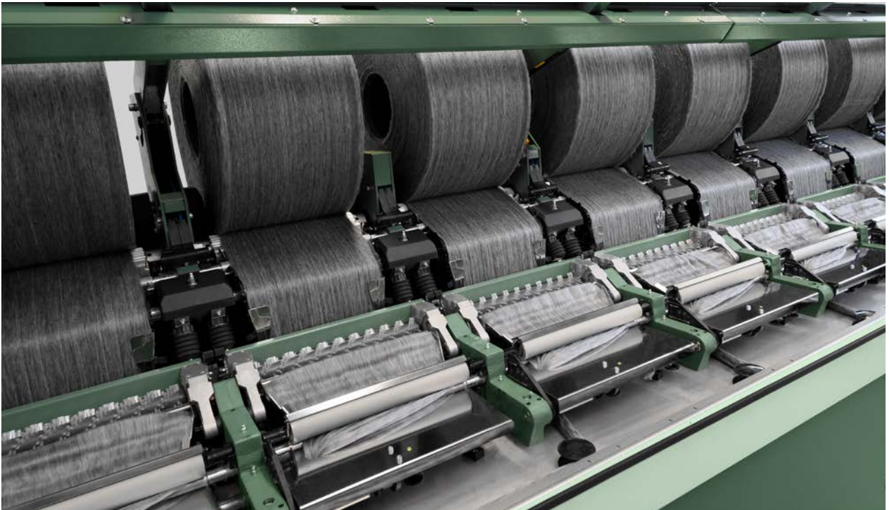
Fig. 2: Las fibras cortas obstaculizadoras y los neps se eliminan con la peinadora E 90.
