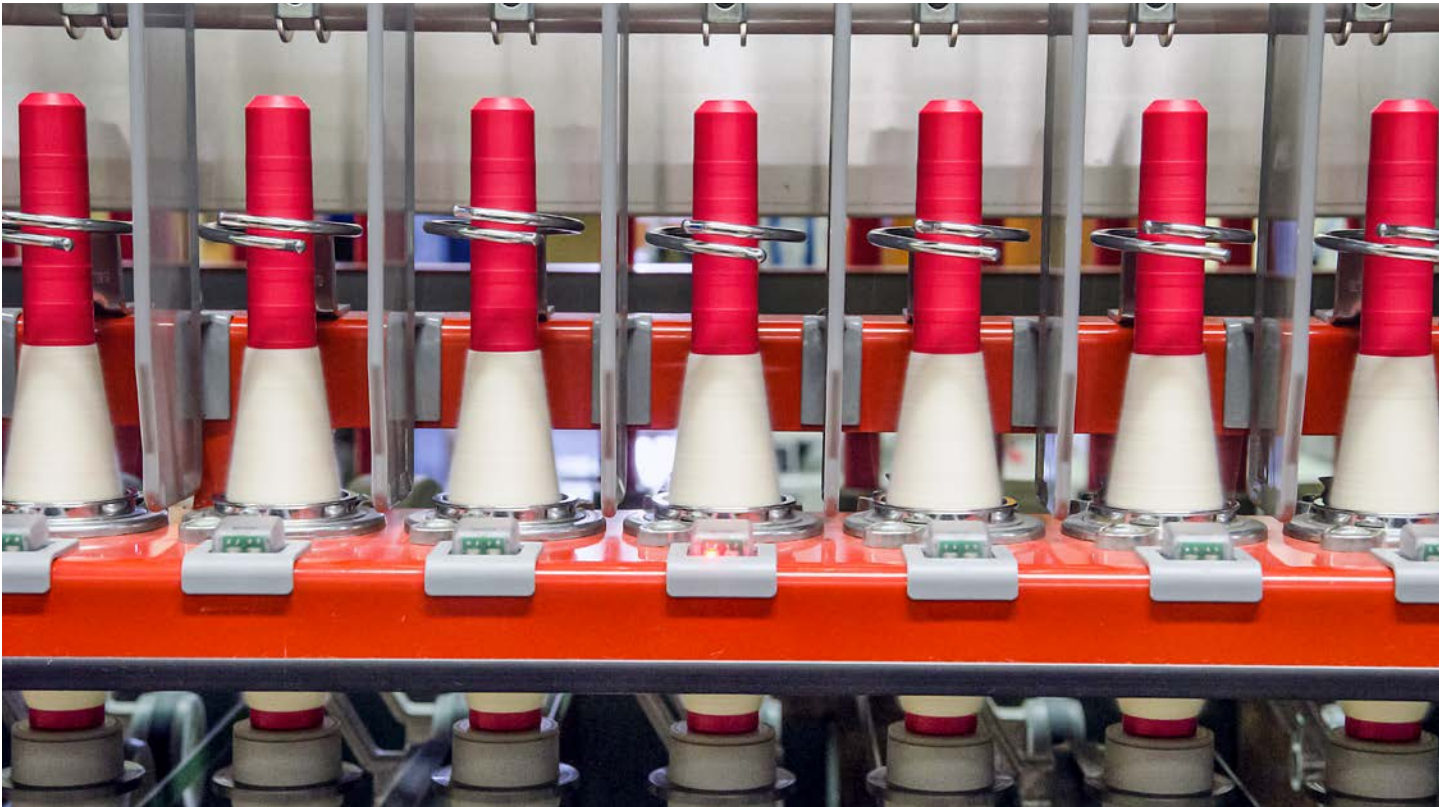
Fig. 3: El sistema de monitoreo de husos individuales (ISM) detecta la unidad de hilatura afectada.
