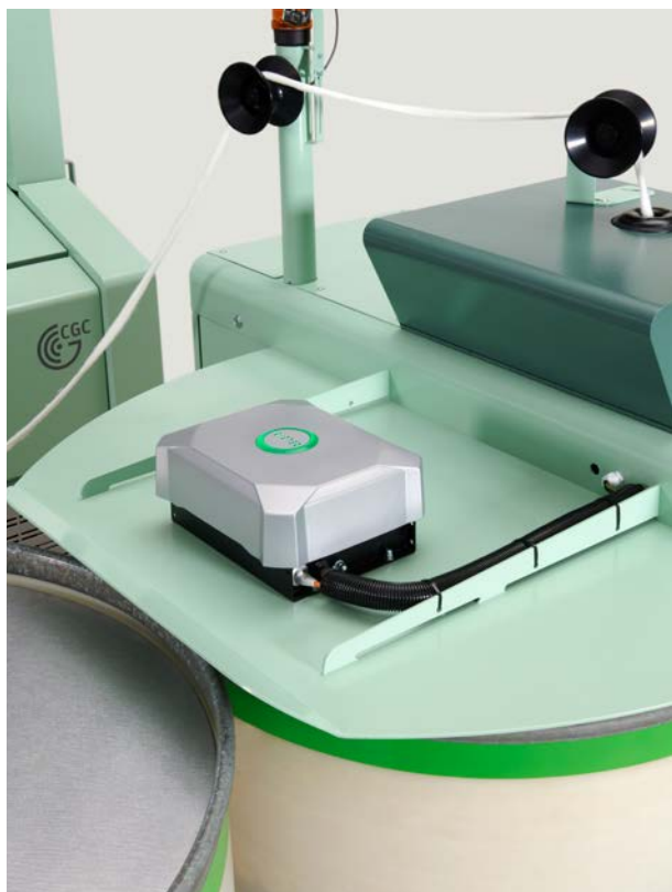
Fig. 2: Monitor del nivel de impurezas en el depósito de cinta de la carda
