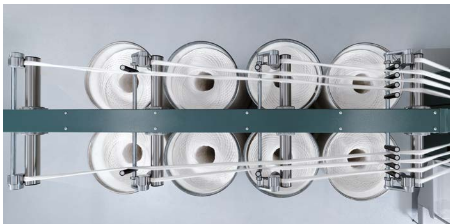
Fig. 2: Alimentación a rodillos reforzada para una mayor robustez
