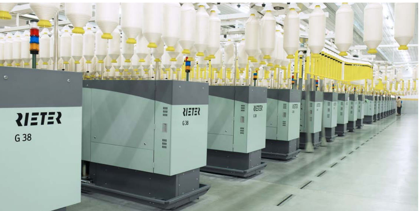
Fig. 1: La probada máquina de hilar a anillos G 38 aumenta la producción de hilo con la Bobina de Alta Velocidad hasta un 15%.
