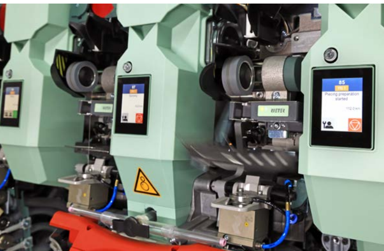
Fig. 4: Funcionamiento simplificado: una pantalla por unidad de hilatura
