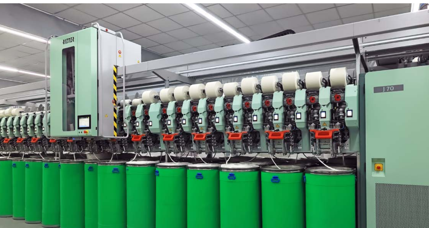
Fig. 1: Máquina de hilatura por chorro de aire J 70 con unidades de hilatura automatizadas de manera individual
